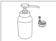
冲洗设施，带有滴定头插件和塞子
